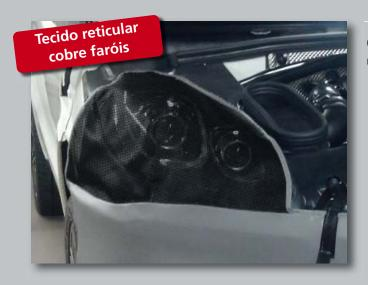
O tecido reticular revestido **sobre os faróis** impede danos por uma acumulação térmica.
